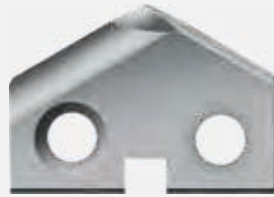
NC-Platte (HSS-E/PM, HSS-E oder HM) mit 90° oder 120° (Je nach \emptyset wird der 90°-Winkel im Spitzenbereich verzerrt)
